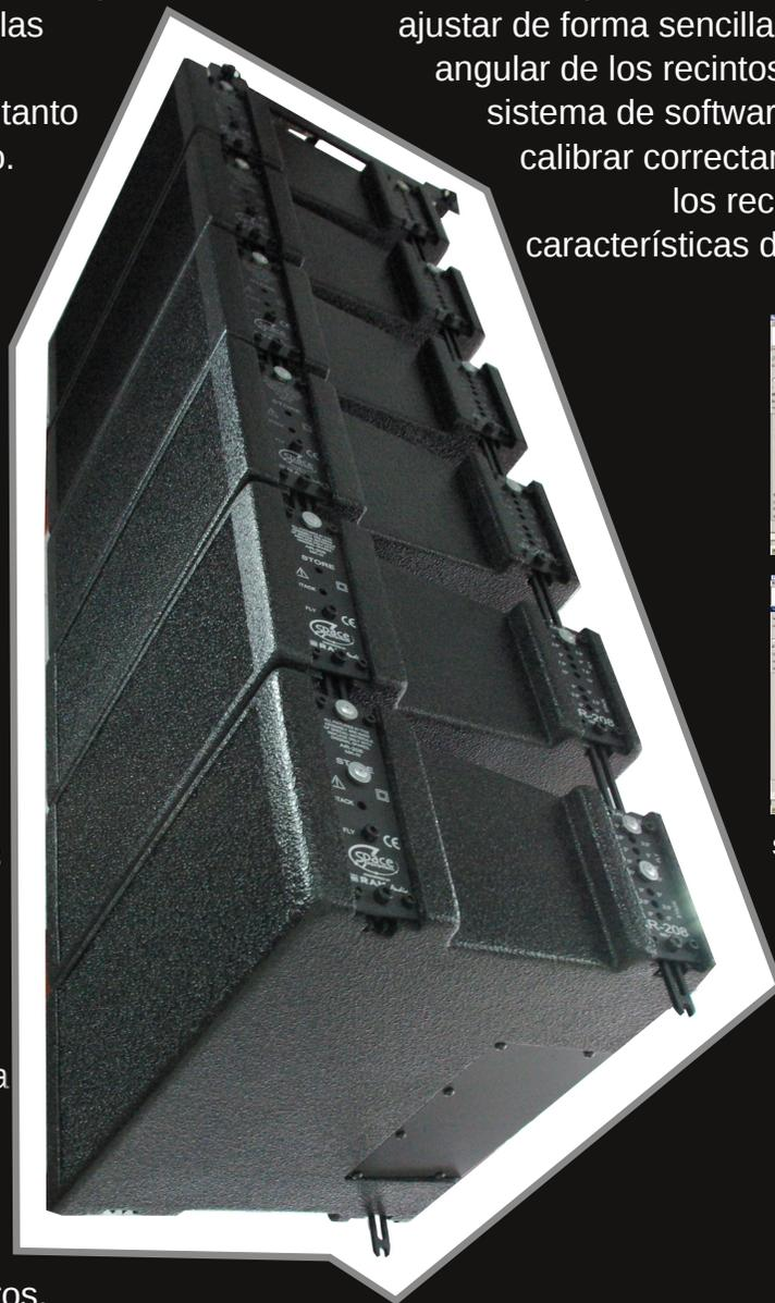
**SENCILLO.** Los recintos se anclan entre sí con un sistema de pasadores imantados que permiten ajustar de forma sencilla la correcta graduación angular de los recintos. Además, mediante el sistema de software **EASE Focus** podrás calibrar correctamente la angulación de los recintos en función de las características del lugar donde se vaya a instalar el sistema.
